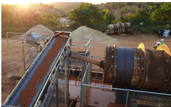
Broyeur à boulets sur le site de Dieu Merci
